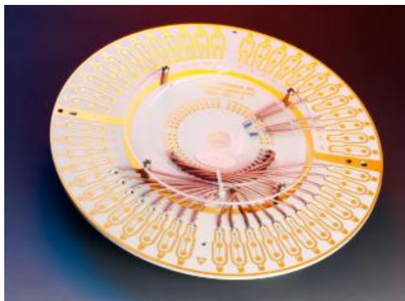
図表 32. STAr のパラメトリックテスト用プローブカード
